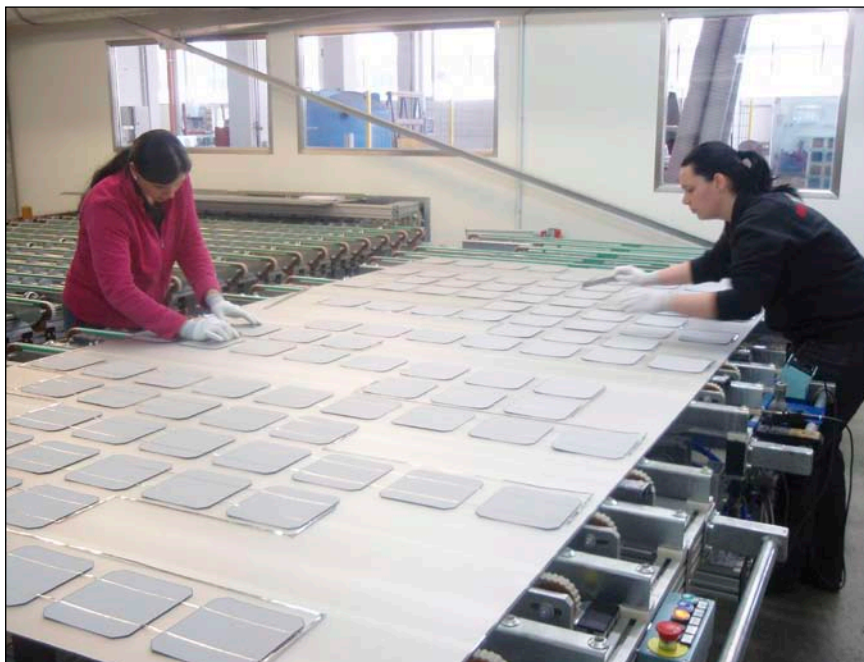
Bild 5: Bei der Produktion von BIPV-Modulen ist viel Handarbeit gefragt. Hier werden bei Ertex Solartechnik die Solarzellen nach ihrer Position ausgerichtet und die stromführenden Leiterbahnen angebracht.
